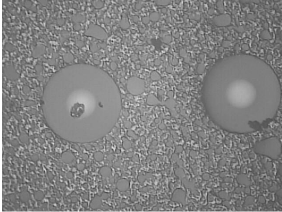
Contamination par poussière (connecteur MPO)
