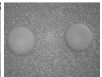
Anneau de poussières dû à une contamination d'accouplement sur un connecteur MPO Dust ring caused by coupling contamination on an MPO connector
