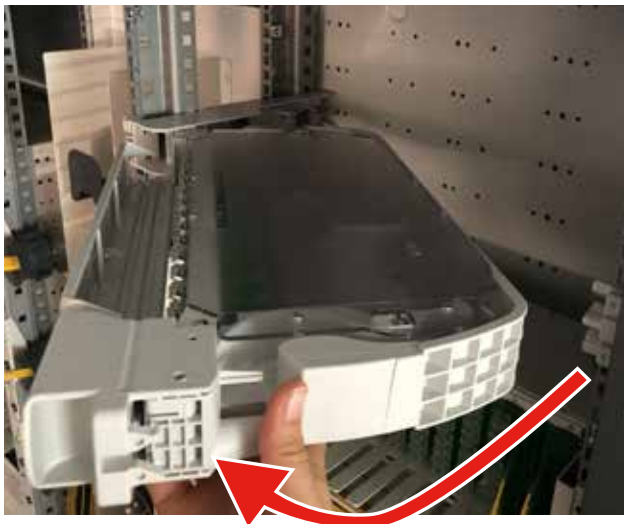
1 Ouvrir le battant Open the swiveling chassis
